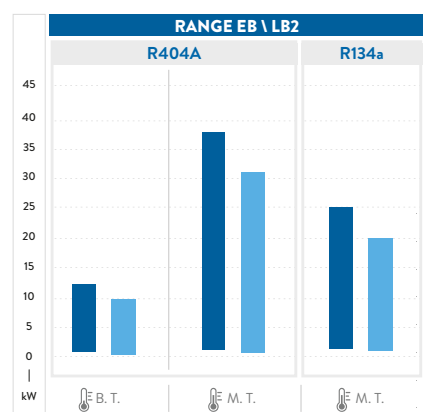
Riferimento dati condizioni di prova : M.T.: capacità di raffreddamento @32°C ambiente T.; evap. T. -10°C B.T.: capacità di raffreddamento @32°C ambiente T.; evap. T. -35°C
