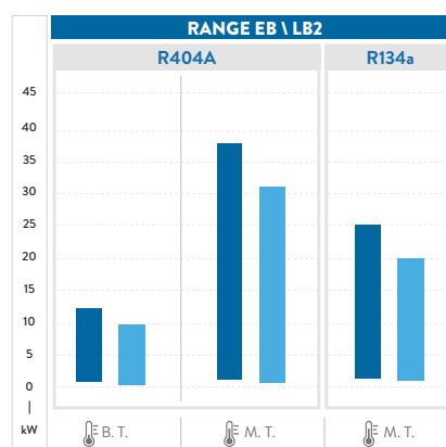
Riferimento dati condizioni di prova : M.T.: capacità di raffreddamento @32°C ambiente T.; evap. T. -10°C B.T.: capacità di raffreddamento @32°C ambiente T.; evap. T. -35°C
