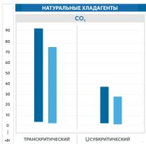
Условия проведения испытаний: Пранскритическая Т. исп. -10° С; Охладитель газа наружный Т. 33° С; (давление газоохладителя 83,7 бар; Перегрев 10К; Субкритическая Т. исп. -30° С, конд. Т. + 10° С; Перегрев 10К;
