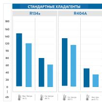
Условия проведения испытаний: H.T.: исп. Т. +5°C; конд. Т. +50°C M.T.: исп. Т. -10°C; конд. Т. +45° С L.T.: исп. Т. -35°C; конд. Т. +40°C
