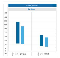
Условия проведения испытаний: M.T.: исп. Т. -10°C; конд. Т. + 45° C L.T.: исп. Т. -35°C; конд. Т. +40°C эко
